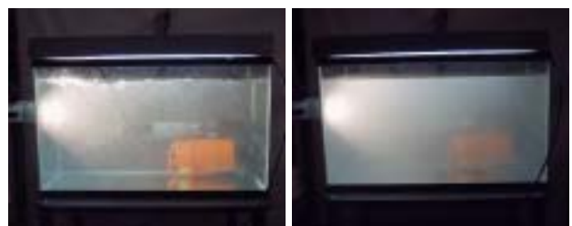
(G) OHR ラインミキサー (F) キャビテーションノズル 図4 マイクロバブル発生1分後の循環水槽内の様子
