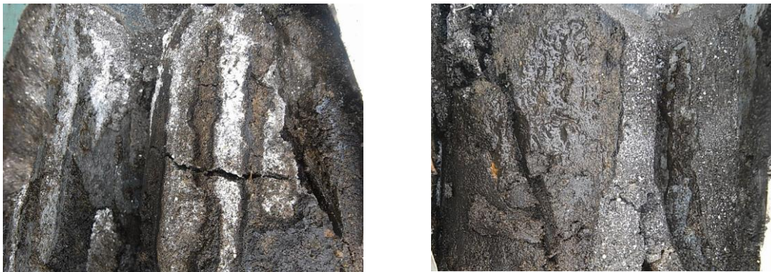
写真5 土壌断面（左：水+消石灰、右：MNB+消石灰）
