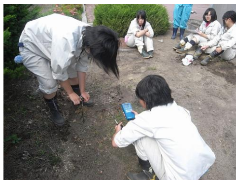
写真6 土壌酸素濃度の測定
